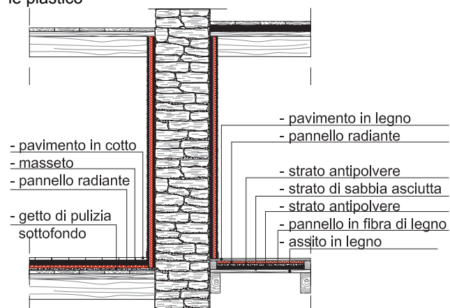
D -isolamento termico di solaio in legno confinante con un locale sottostante non riscaldato
